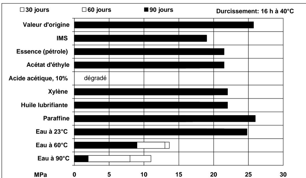
**Test de pelage au rouleau (ISO 4578)** Durcissement 16 heures à 40°C 5 N/mm
