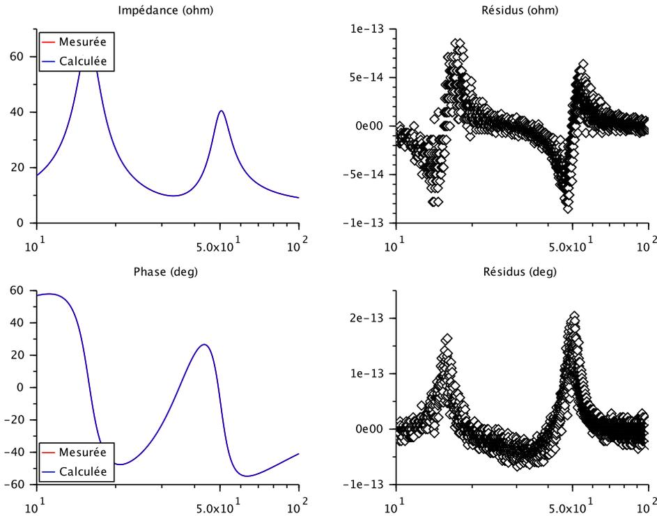
FIGURE 2.11 – Courbes de mesure de l'enceinte à évent
