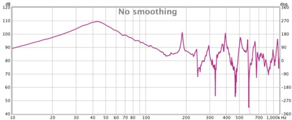
FIGURE 3.6 – Courbe de réponse mesurée cas A
