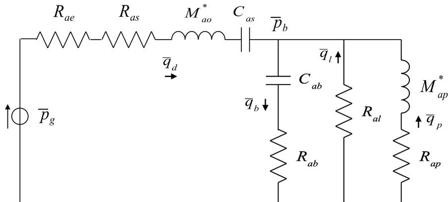
FIGURE 1.11 – Synthèse du schéma acoustique de l'enceinte à event
