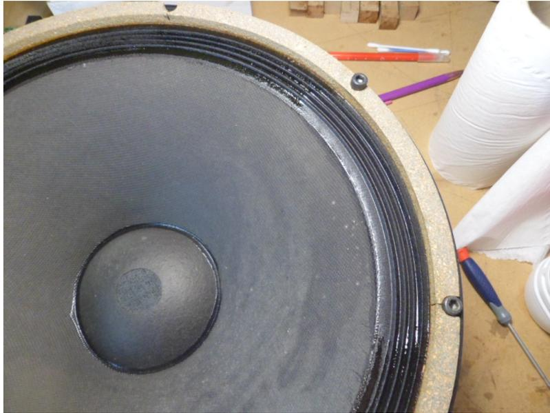
FIGURE 3.1 – Nettoyage de la suspension
