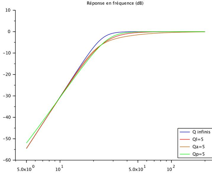
FIGURE 1.12 – Effet des pertes sur la courbe de réponse
