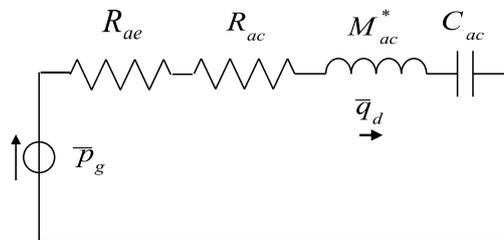
FIGURE 1.7 – Synthèse du schéma acoustique de l'enceinte close
