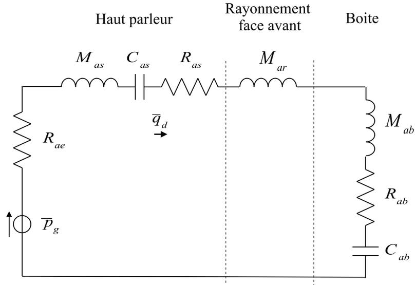
FIGURE 1.6 – Schéma acoustique de l'enceinte close
