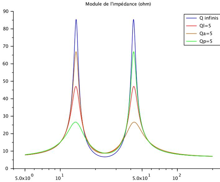
FIGURE 1.15 – Effet des pertes sur la courbe d'impédance
