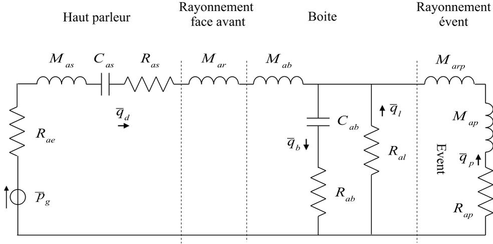
FIGURE 1.10 – Schéma acoustique de l'enceinte à event
