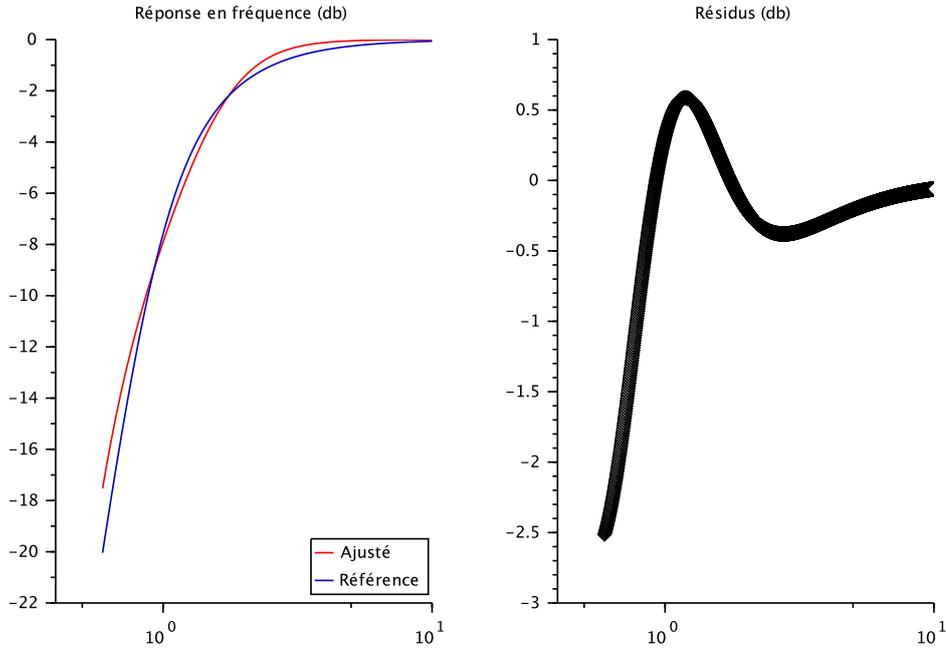
FIGURE 2.9 – Courbes d’ajustement Bessel avec  $Q_{to}$  de 0.37
