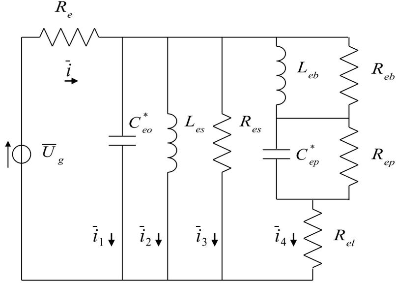
FIGURE 1.14 – Schéma électrique de l'enceinte à event
