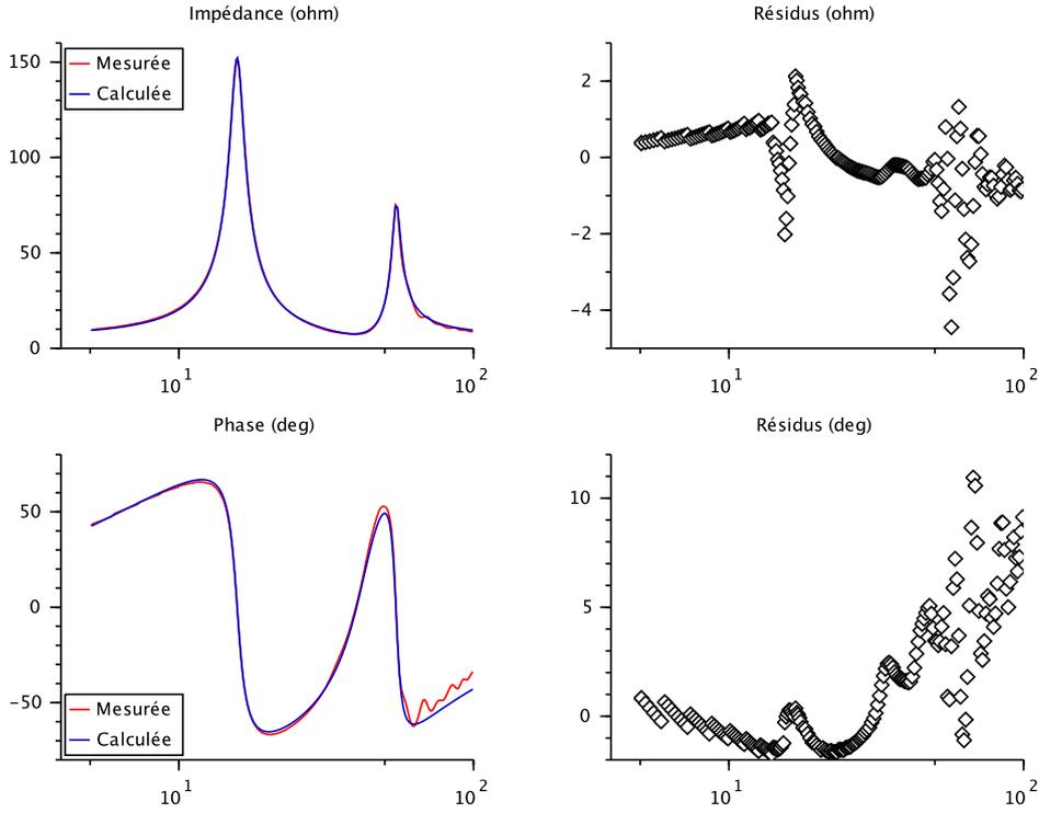
FIGURE 3.5 – Résidus d'ajustement sur l'amplitude et la phase
