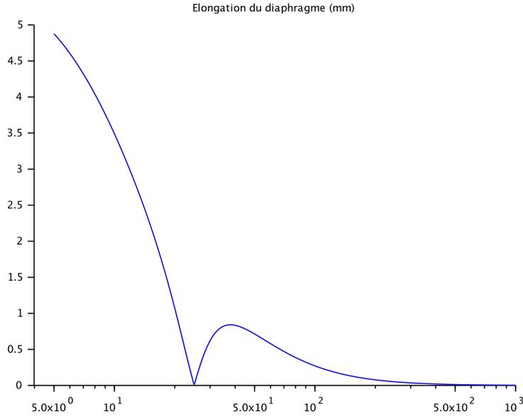
FIGURE 1.13 – Elongation du diaphragme dans une enceinte bass-reflex
