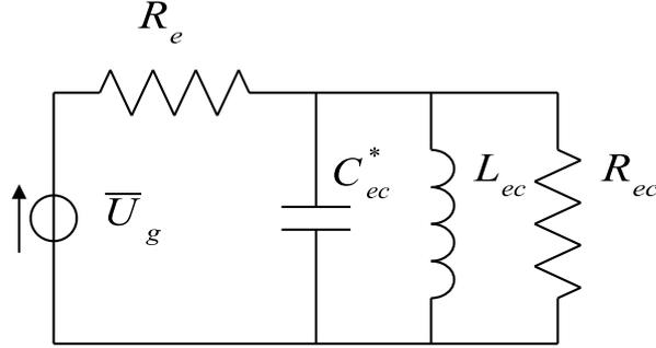
FIGURE 1.8 – Schema électrique de l'enceinte close
