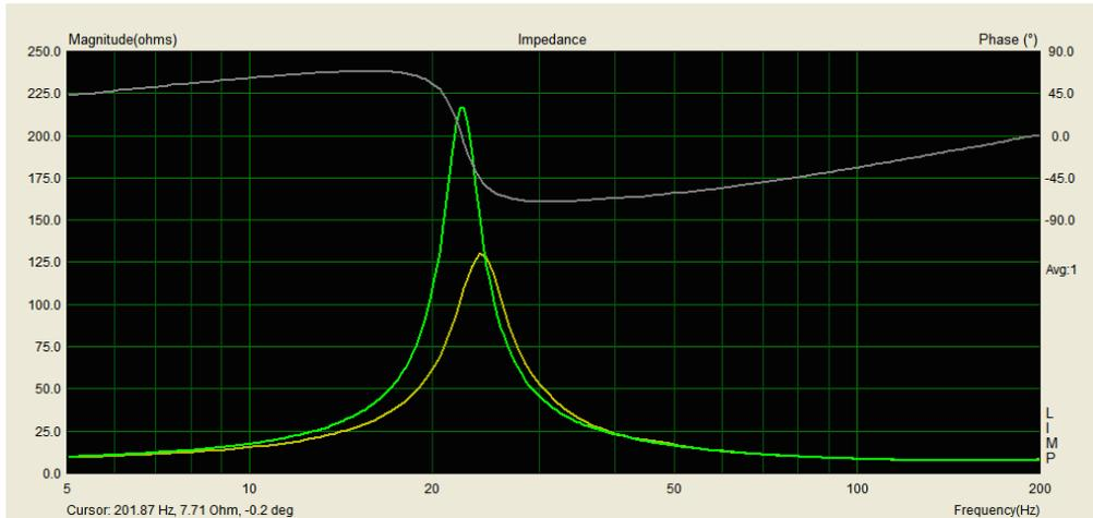
FIGURE 3.2 – Effet du nettoyage de la suspension sur l'impédance
