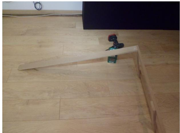
FIGURE 4 – Assemblage des cotés entre eux
